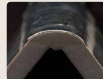
Een stabiele boog zorgt voor een gladde las en een sterke aanhechting op het basismateriaal. Dit zorgt voor goede mechanische eigenschappen van de las.
