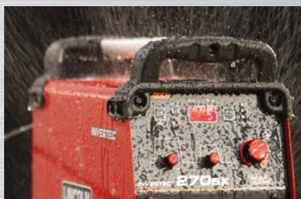
Het testen van de IP waarde in het laboratorium.
