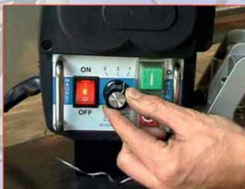
Automatischer Bohrbetrieb für Kernbohrer von 14 - 30 mm Handbetrieb von 12 - 35 mm Automatic drilling for core drills from 14 to 30 mm Hand operation from 12 to 35 mm
